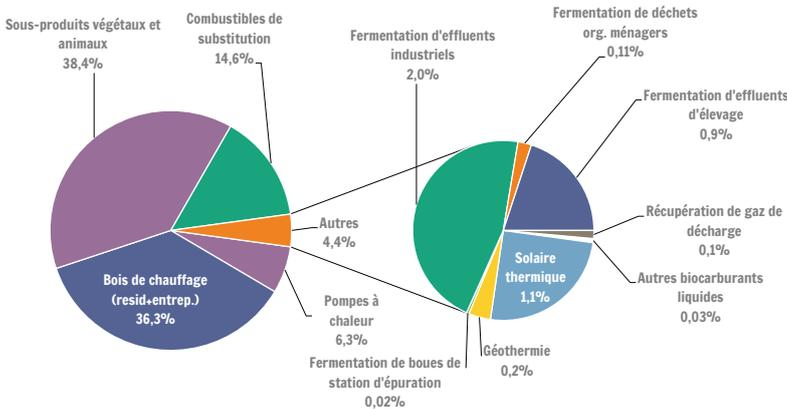
La production de chaleur nette s'élève à 10 751 GWh en 2022, en hausse de 3 % par rapport à 2021. Elle est principalement assurée par les énergies de type biomasse, en particulier la biomasse solide.
